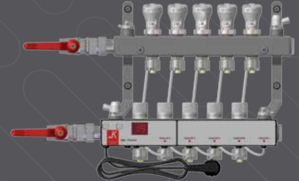
Ortam seviyesinde ısıtma ve soğutma için dijital 868 Mhz 2 yönlü iletişim Opti-Global, ayarlanabilir basınç dengeli geçme valfler ve çok amaçlı bir termomotorun kullanımı için M-30 vida dişliyle donatılan ayarlanabilir geçme valflere sahip paslanmaz çelik-LT dağıtıcı.
