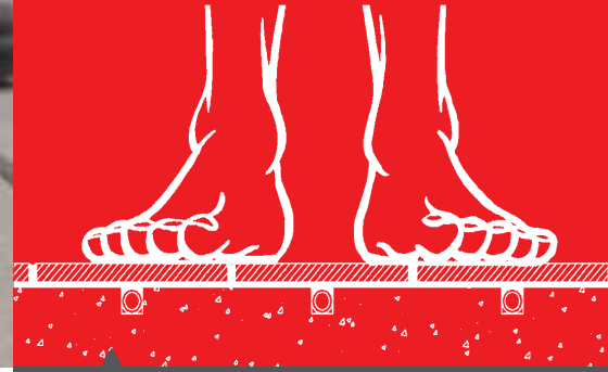
Isıtma boruları döşemenin hemen altına yerleştirildiğinden dolayı, daha hızlı ısıtma sağlanır ve ısı ayarı daha hassas bir şekilde kontrol edilir.
