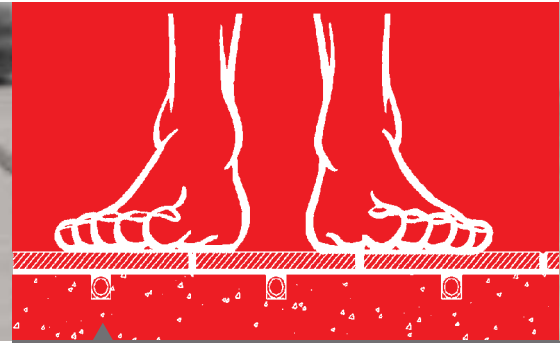
Isıtma borularının döşemenin hemen altından geçmesinden dolayı, daha hızlı ısıtma sağlanır ve ısı ayarı daha hassas bir şekilde kontrol edilebilir.
